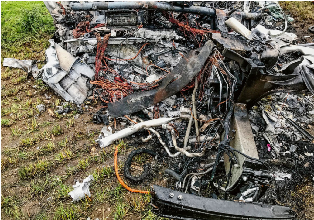
Cette photo est celle d'une Tesla qui a brûlé. La Tesla modèle S emmène un accumulateur à haute tension sous le plancher.
